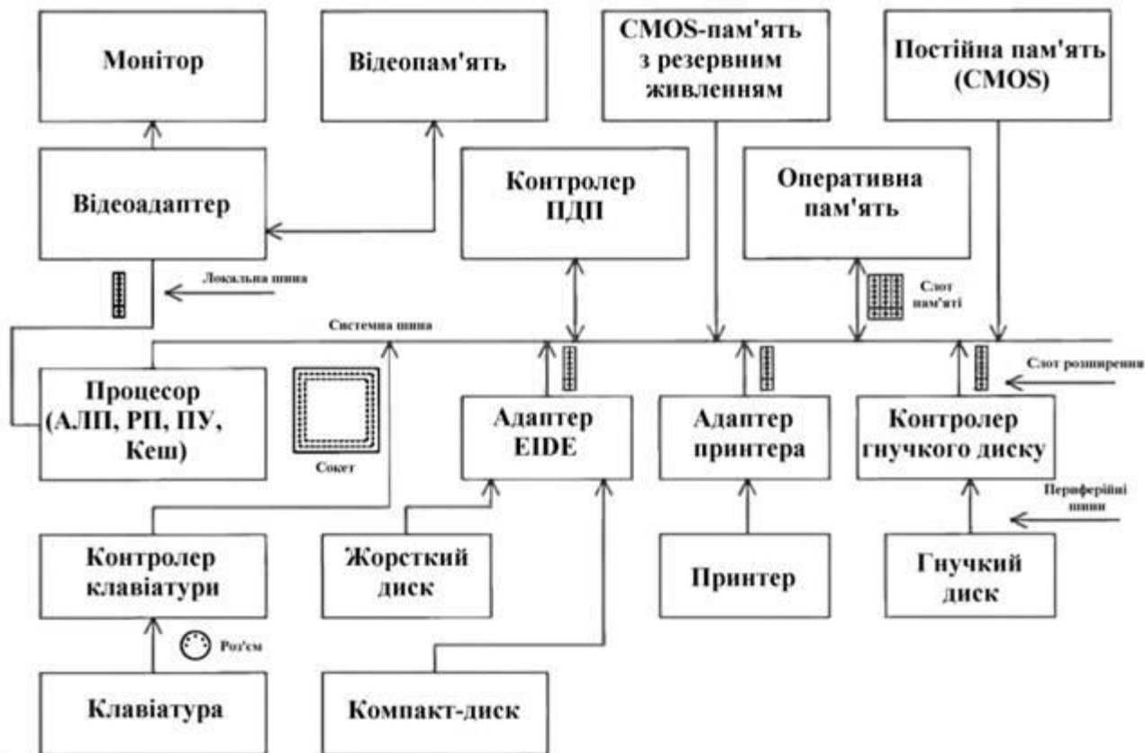
Рисунок 2.1. Схема базового ПК
