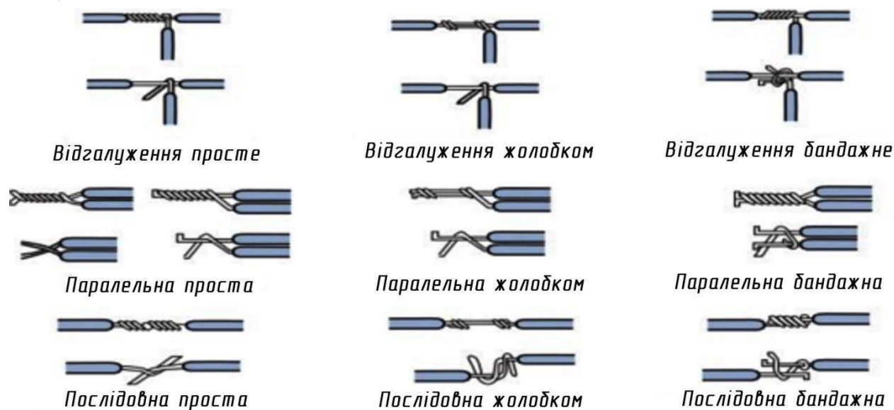
Мал. 28.3. З'єднання мідних жил скручуванням
