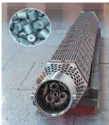
Рис. 42.4. ТВЕЛ (тепловідільний елемент) — пристрій, у якому міститься ядерне паливо (таблетки уран(IV) оксиду, збагаченого ізотопом {}^{235}_{92}\text{U} )
